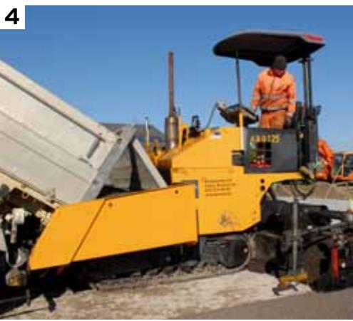
**1 ABG Titan 7820 VDT** Finisseur sur chenilles avec filtre à particules, poutre à haut pouvoir de compactage, poids 18,2 t, largeur standard 2,5-5,00 m, élargissement supplémentaire jusqu'à 9,00 m, réglage de la hauteur avec système électronique à ultrasons, réglage de la hauteur avec système de commande laser pour le revêtement de places de sport. Optimale pour la pose de matériaux à liant hydraulique ainsi que de tous enrobés bitumineux.
